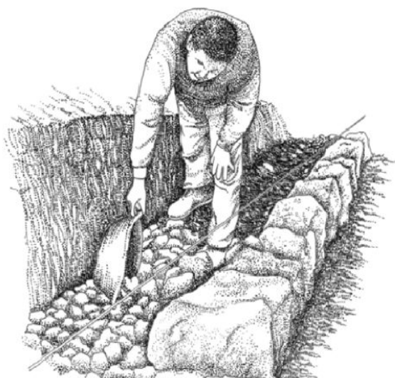
Etape de lit d'assise
