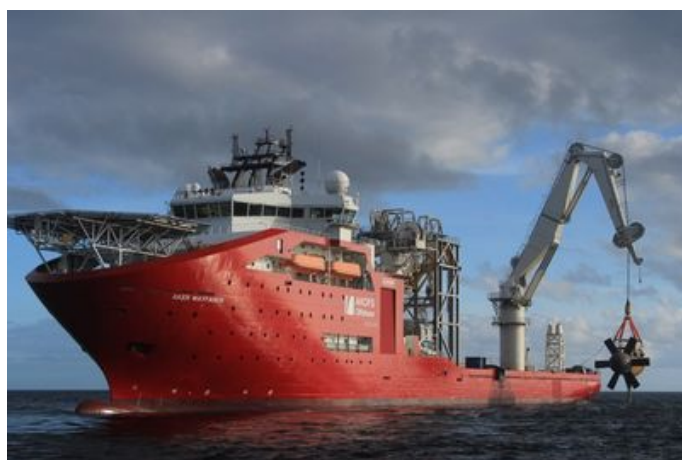
Relevage de la turbine D10 en juillet 2016
